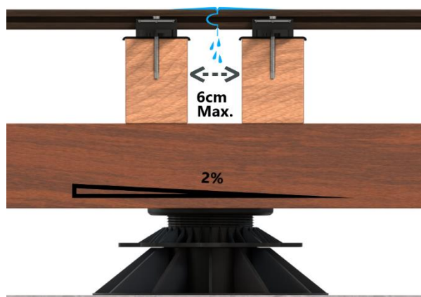
Figuur 3: Dubbele onderconstructie met dubbele onderbalk bij de uiteindes van de terrasplanken. Plaats de balken niet verder dan 6cm uit elkaar.
